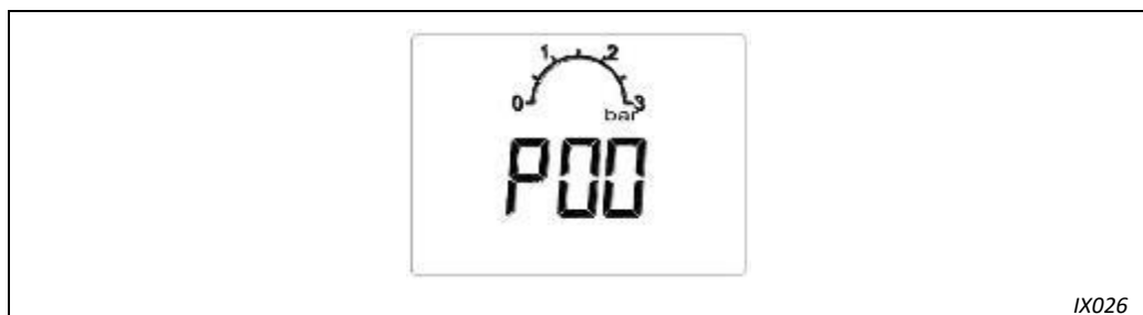
Obr. 17: Ukazatele na displeji: první číslo parametrů „P00“
