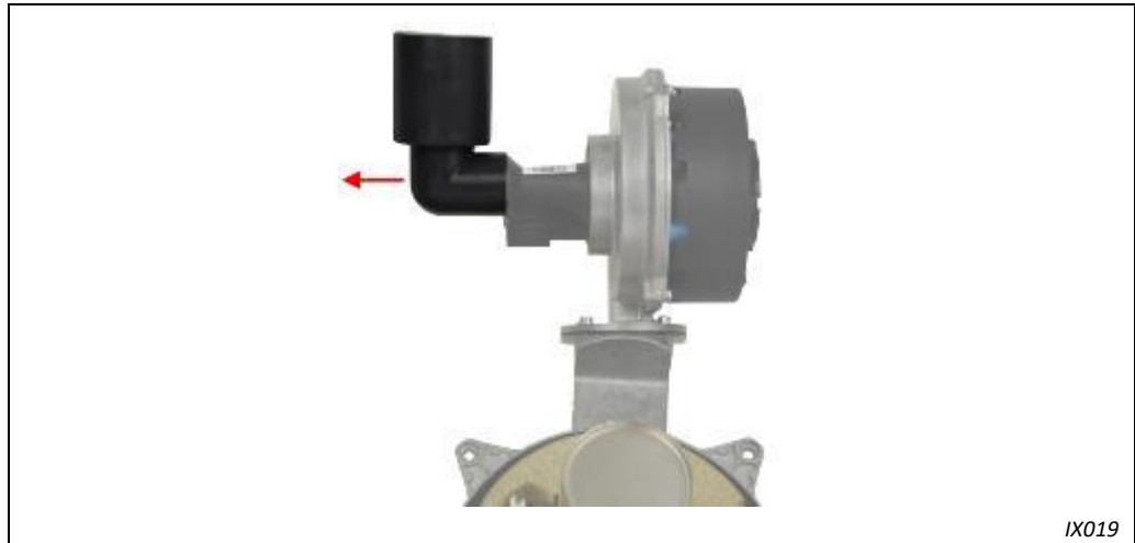
Obr. 31: Stáhnutí tlumiče hluku
